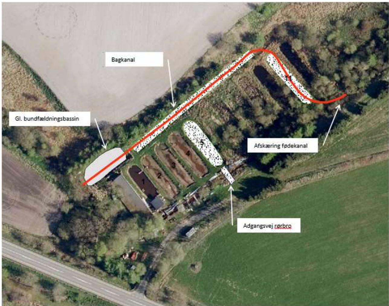
Figur 2. Luftfoto detail kort: Optegnet nyt forløb (rød streg), opfyldt adgangsvej via dam 5 og tilførsel af råjord til bagkanal og dam 11 (sort/hvid broget markering), samt bundfældningsbassin (grå).
