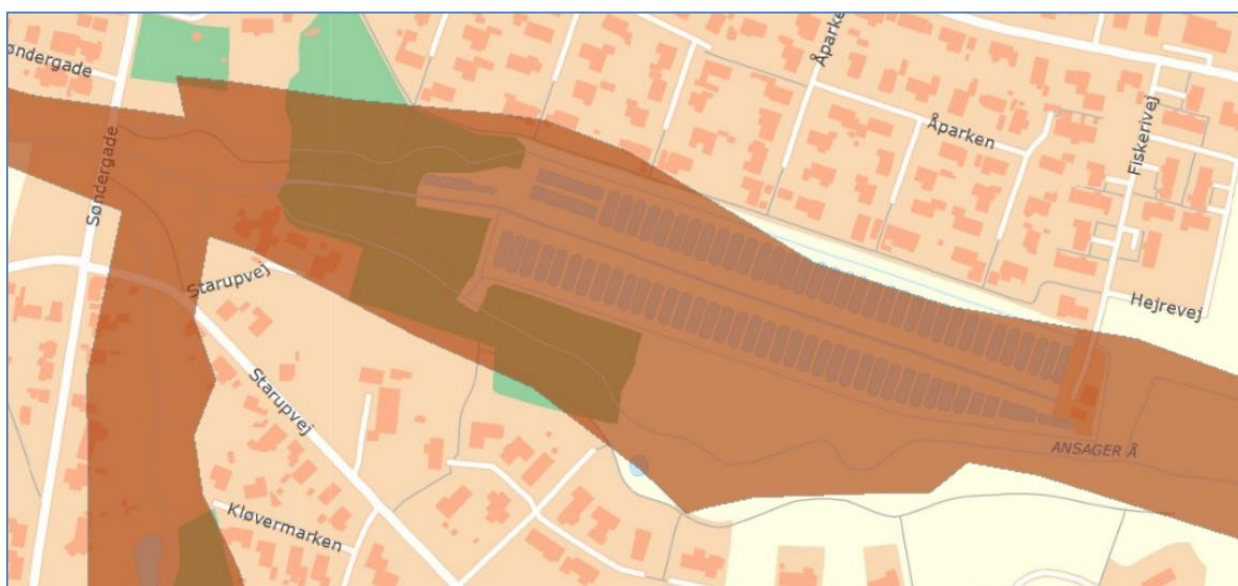
Fig. 15. Engen, hvor stryget ønskes anlagt er klassificeret som okkerpotentielt KI. I. Stor risiko for okkerudledning.
