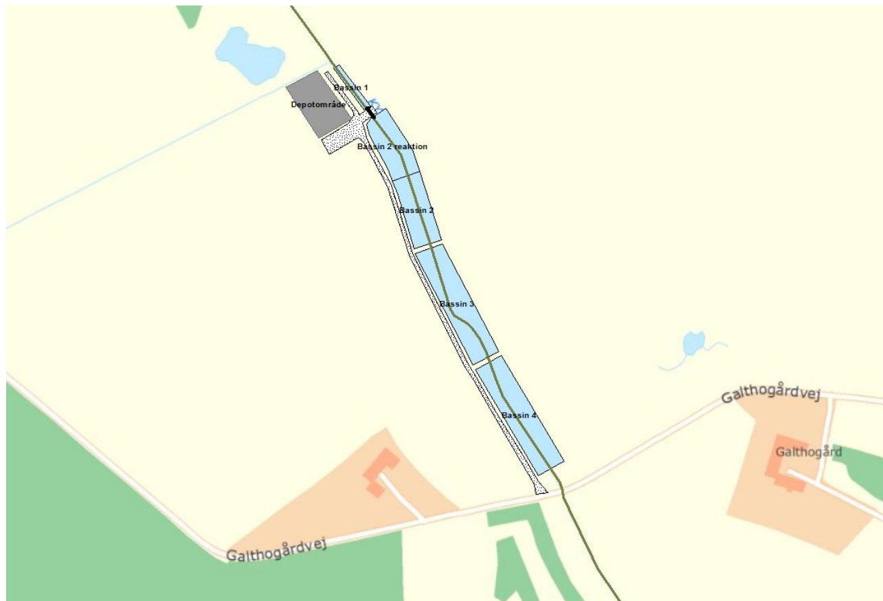
Figur 18. Placering og udformning af okkerbassiner, depot, adgangsvej.
