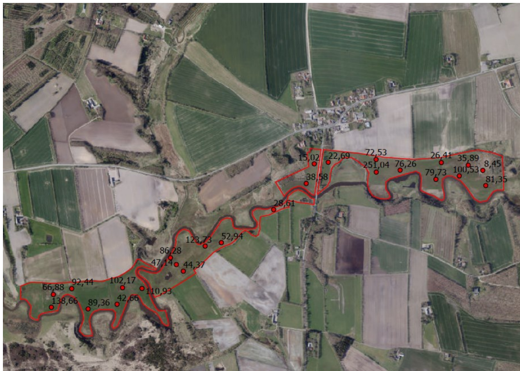
Figur 3-11. Punkter anvendt ved prøvetagning af jordprøver (volumenprøverne). Tal angiver Fe:P-molforhold for de enkelte prøver. De røde polygoner er undersøgelsesområdet.
