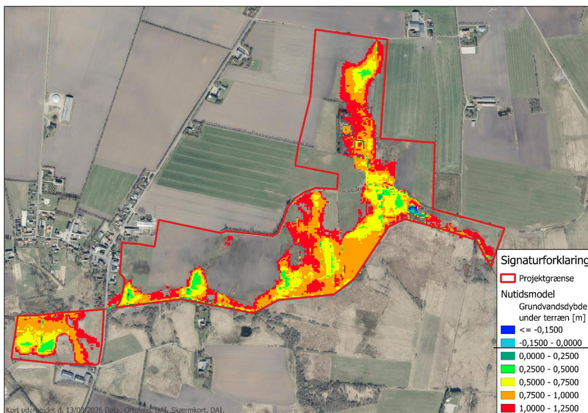
Figur 3. Modellering af årsmiddel grundvandsstand i området, baseret på indmålte grundvandsstande.
