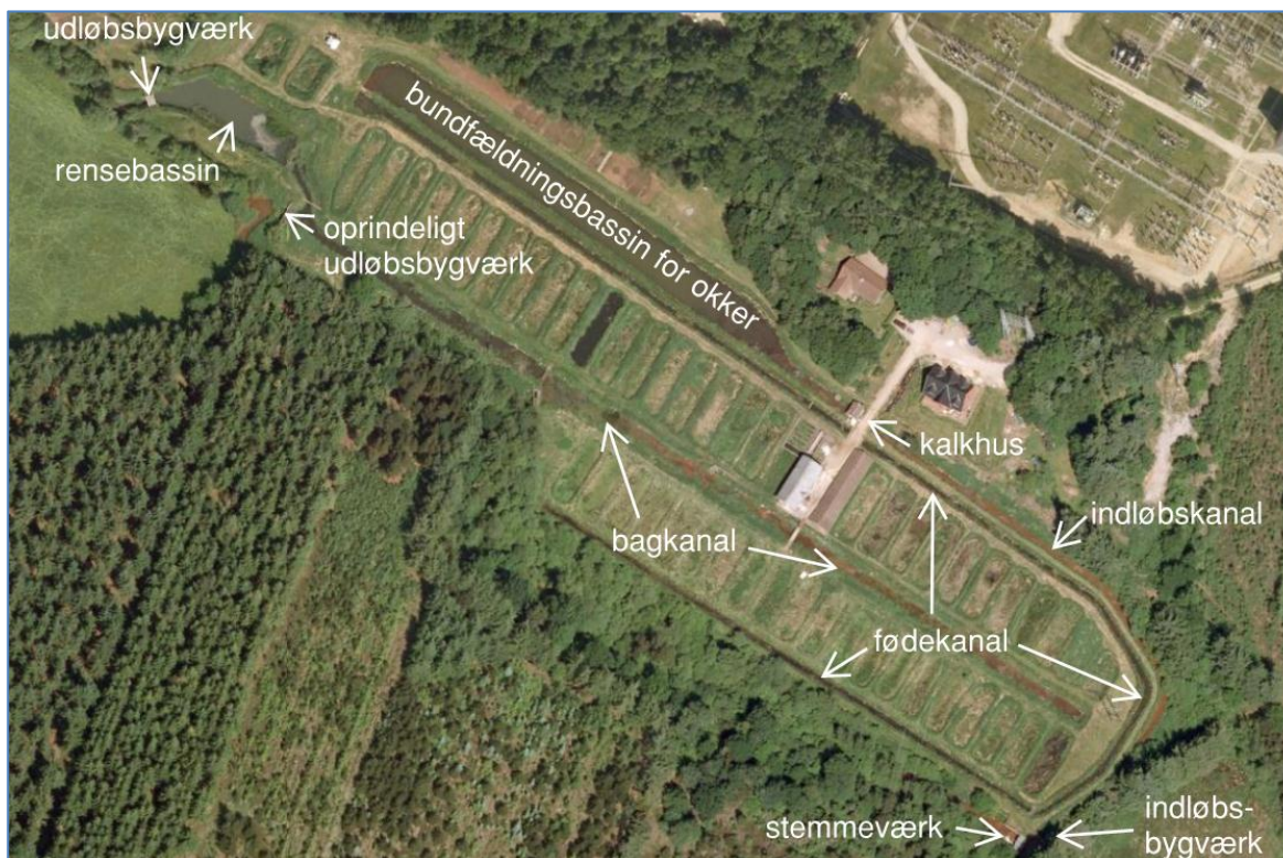
Fig. 3. Oversigt over dambrugets indretning
