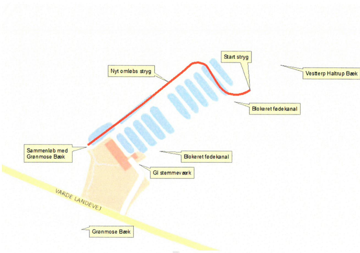
Figur 2. Strygforløbet vest/nordvest om dambrugsarealet. Vandløbet er et tilløb til Holme Å i Varde Å vandsystemet.
