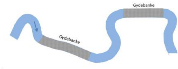
Figur 3-7 Gydebankerne etableres på de lige strækninger af vandløbet, hvor der naturligt burde være stryg og hvor gydegruset ikke skyller væk. Stryg = lavvandede sten- og grusbanker i det naturlige vandløb.
