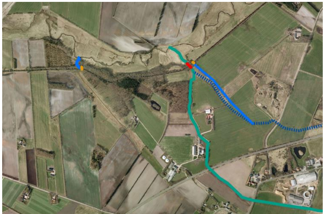
Figur 3-8 Oversigtskort over Øselundområdet. Kortet viser Foot Bæk (grøn) og underføring (rød), dæmningerne i hver ende af Øselund Sø (orange), Kloakgrøften nuværende forløb (stiplet blå), ny rørlægning af Kloakgrøften og ny rørlægning fra overløb af Øselund Sø til Holme Å (blå).
