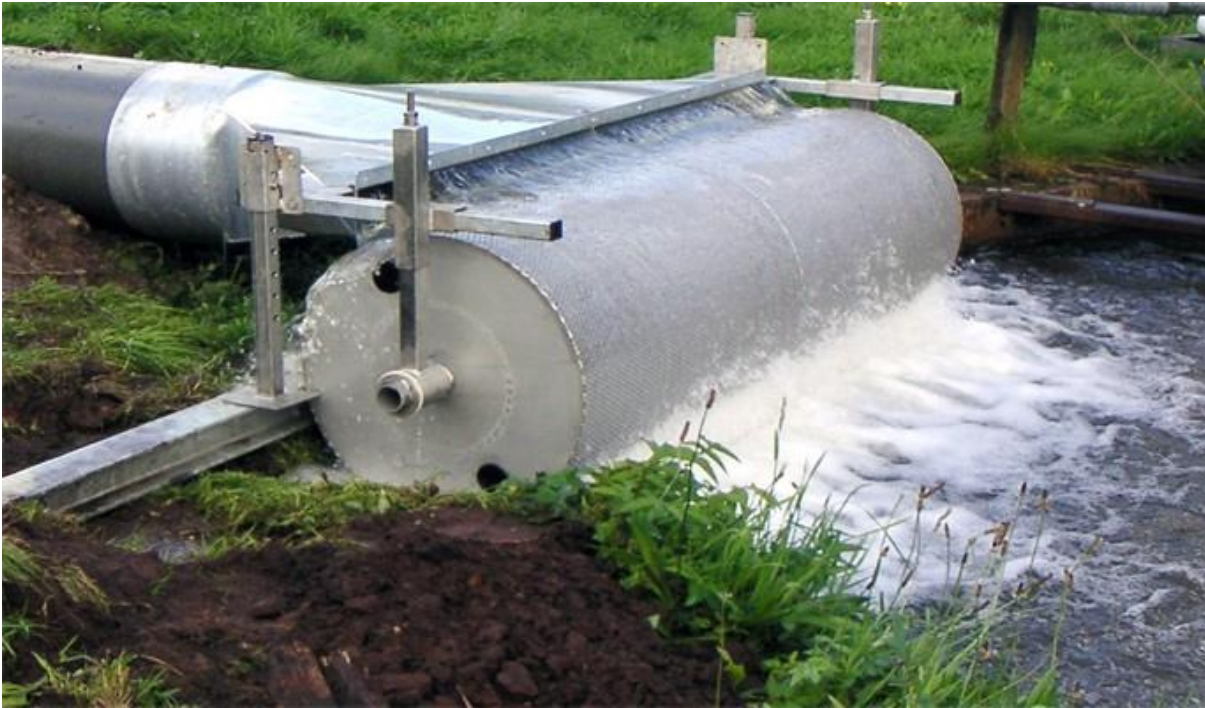
Figur 7. Eksempel på ilttromle. Kilde Grimstrup Maskinforretning.
