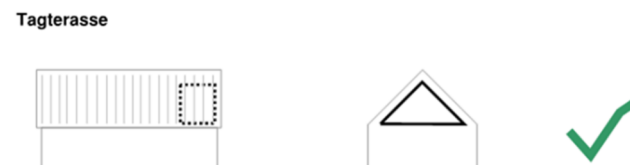
Figur 16 Princip for placering af tagterasse, som del af 1. sal ved udnyttet tagetage. Integreret altan.
