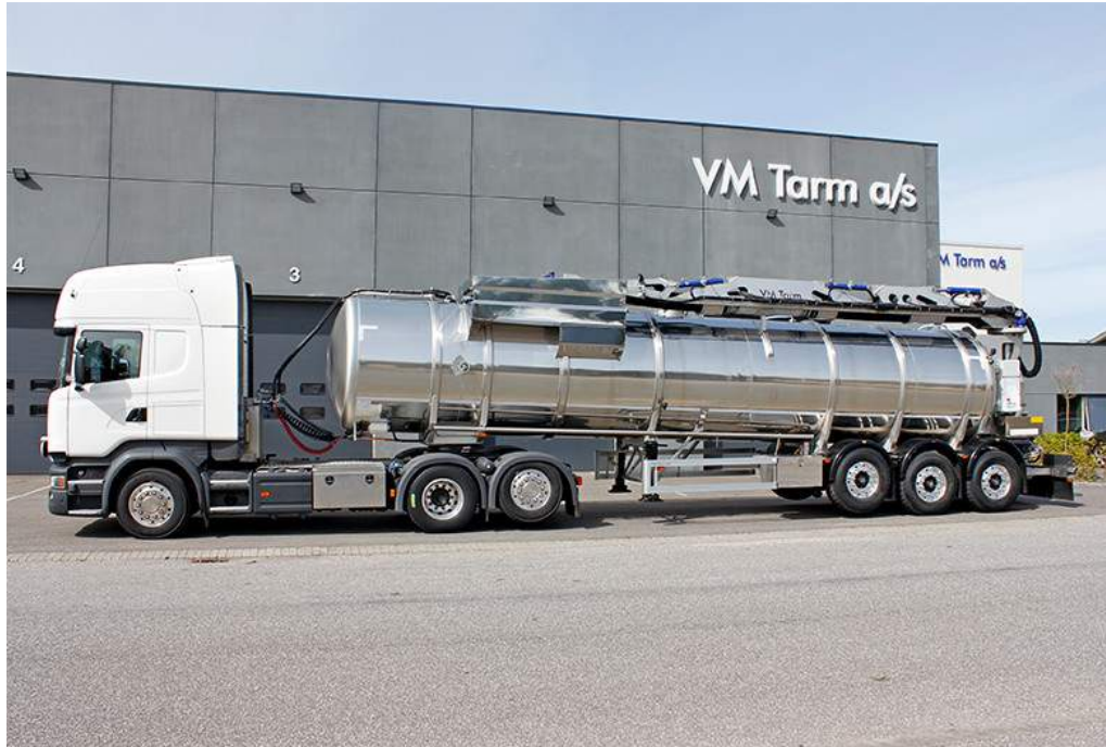
Figur 10 Eksempel på gylletrailer fra firmaet VM Tarm (foto: VM Tarm)
