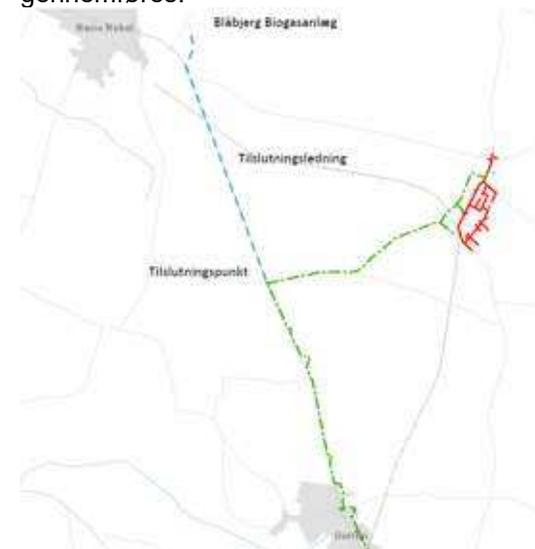
Figur 4: Tilslutningsledning er markeret med blå.
