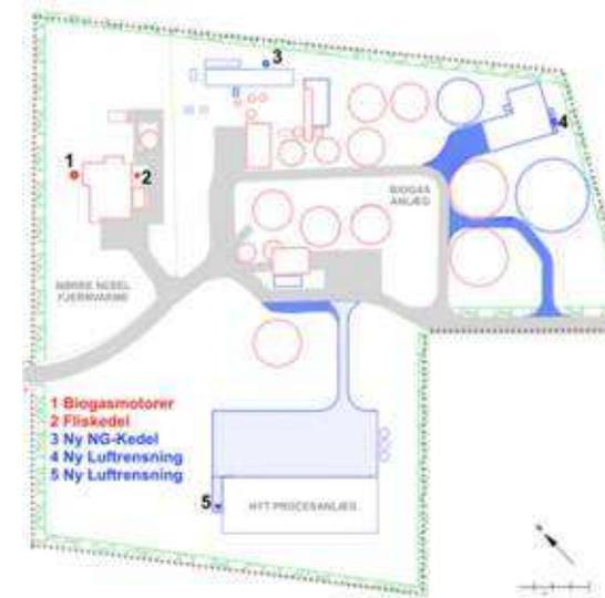
Figur 20 Eksempel på placering af nuværende og fremtidige luftafkast.
