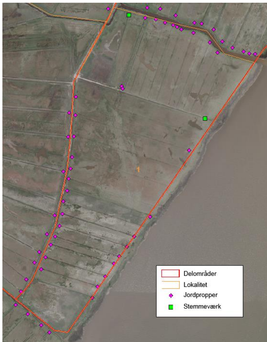
Figur 5-3 Lokalitet 1. Afvanding i området er begrænset som følge af lukkede grøfter (Jordpropper, lilla ruder) samt stemmeværker, markeret med grønne firkanter.
