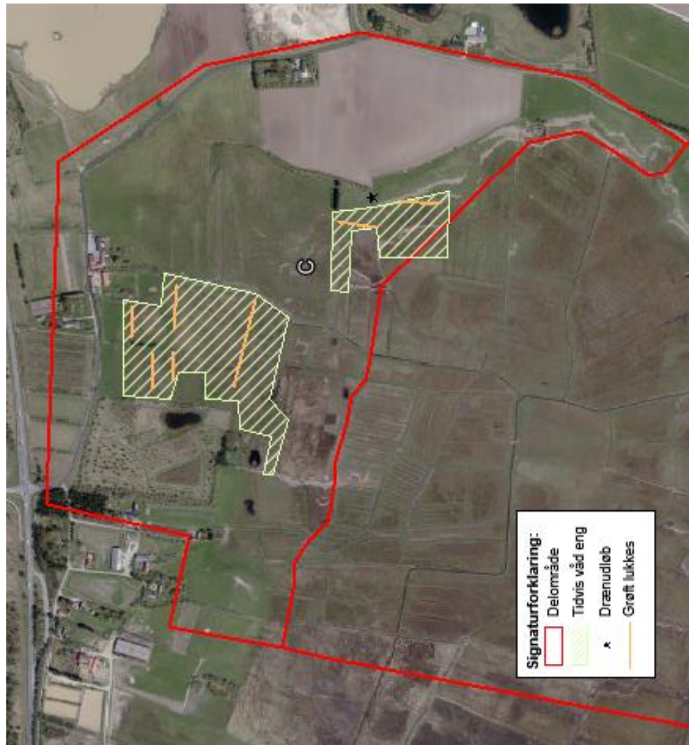
Figur 6-6. Lukke grøfter. Læg mærke til områder med tidvis våd eng ligger i de områder hvor grøfterne skal lukkes. Der er lokaliseret drænudløb op mod marken mod øst.
