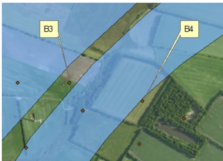
Figur 4: Den ønskede placering af borerne B3 og B4 i forhold til indvindingsoplandene for Jegum-Vrøgum Vandværk (blå markering til venstre) og Janderup Vandværk (blå markering til højre).
