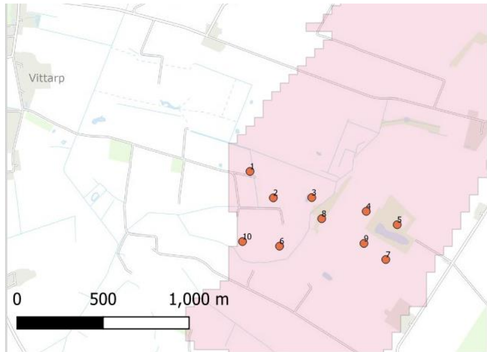
Figur 3.1: Oversigt over placering af boringer ved Vittarp Kildeplads med angivelse af den kortlagte begravede dal
