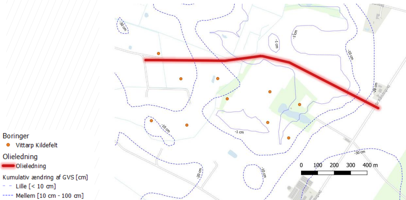
Figur 3.30: Beregnet kumulativ påvirkning af gasledning nord for kildefelt
