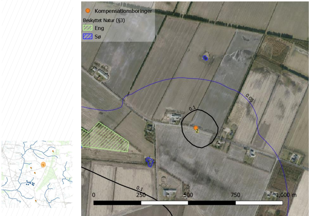
Figur 4.6: Resulterende sænkningstragt efter 3 måneders kompensation på 0,9 l/s til den øvre del af Søvig Bæk.
