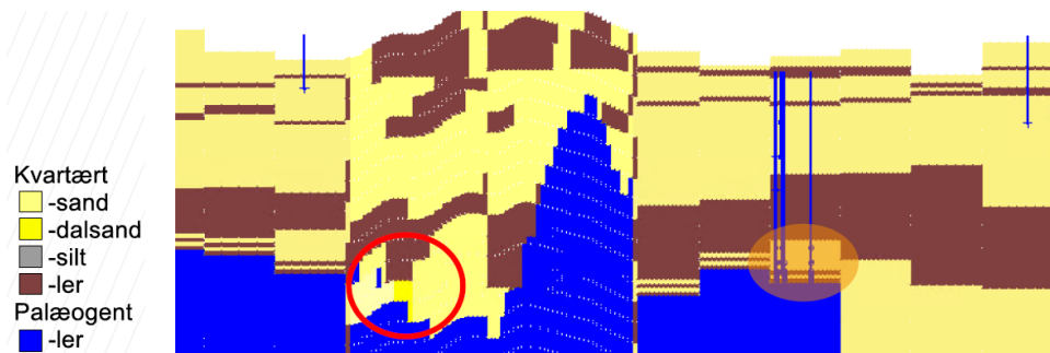
Figur 3.8: Syd-Nord profil gennem kildefeltet ved Jegum-Vrøgum (angivet i orange ellipse). Den begravede dal med Vittarp Kildefelt er angivet med rød Ellipse. Profillængde ca. 10 km.
