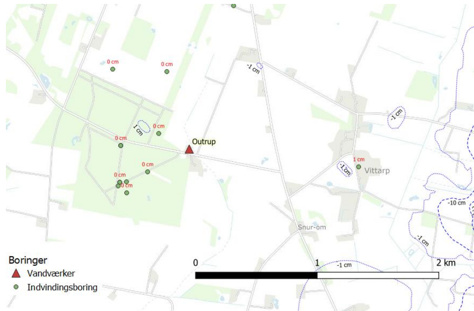
Figur 3.12: Beregnet påvirkning af boringer tilknyttet Outrup Vandværk.
