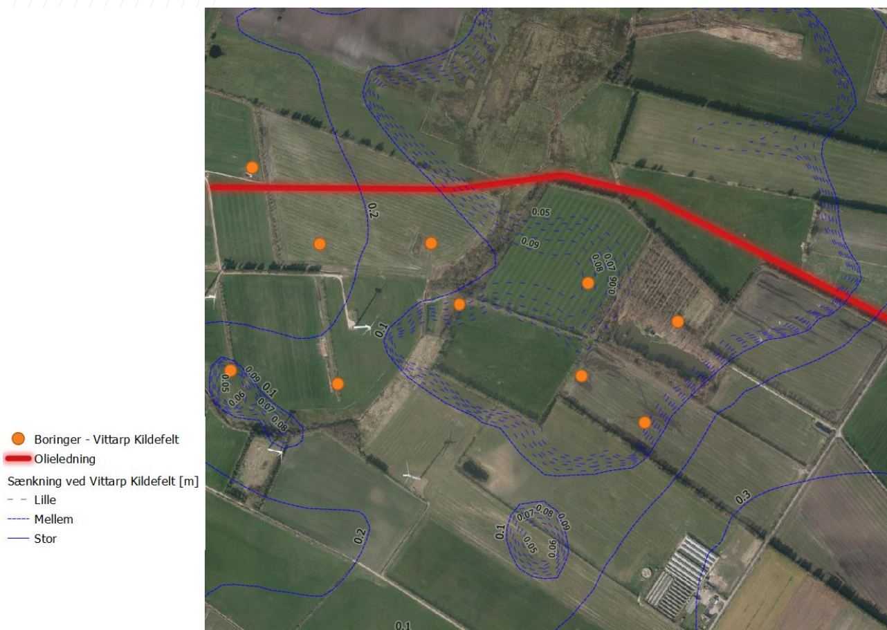
Figur 3.17: Placering af olietransmissionsledning (rød) nord for boringerne til Vittarp Kildeplads.
