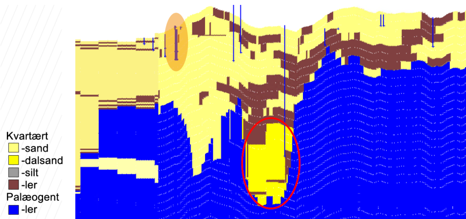
Figur 3.5: Syd-Nord profil gennem kildefeltet ved Janderup (angivet i orange ellipse). Den begravede dal med Vittarp Kildefelt er angivet med rød Ellipse. Profillængde ca. 16 km.
