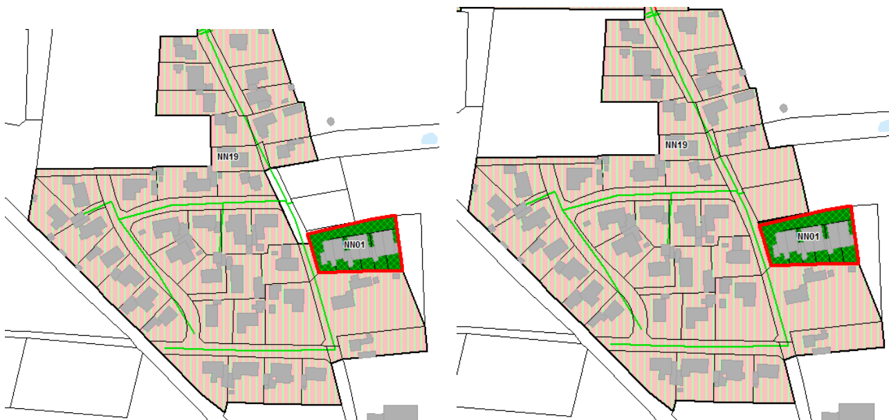
Figur 17 To ejendomme ind i status opland NN19, separatkloakeret.
