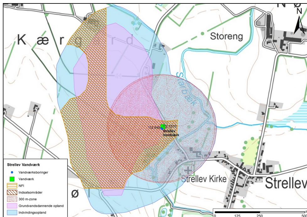
Figur 23: Strellev Vandværk med IVO, GDO, NFI, IO, 300 m-kildepladszoner og indvindingsboringer
