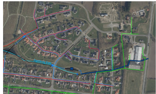
Figur 5 viser forsynings ledninger og vandløb. Grøn markering er fællesledning, blå er regnvand, rød er spildevand, blå/sort er rørlagt kanal/vandløb til regnvand, som opstrøms er et dræn fra blandt andet markerne øst for DLG, lyseblå er vandløb. B betyder bassin til regnvand. Søen, vest for bassinet markeret med B, er etableret som regnvandsbassin i slutningen af 1970'erne - start 1980'erne.
