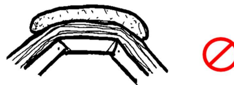
Figur 7 Afslutning på et stråtag, som ikke er lovlig.
