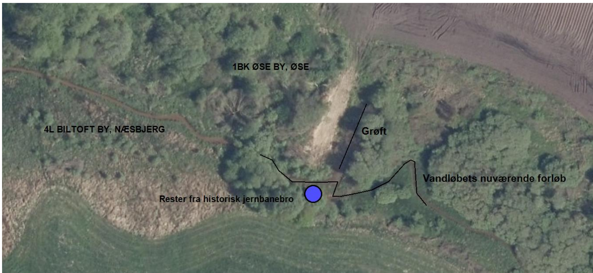
Figur 2. Aktuelt forløb af Nørrebæk med markering af pille fra jernbanebro
