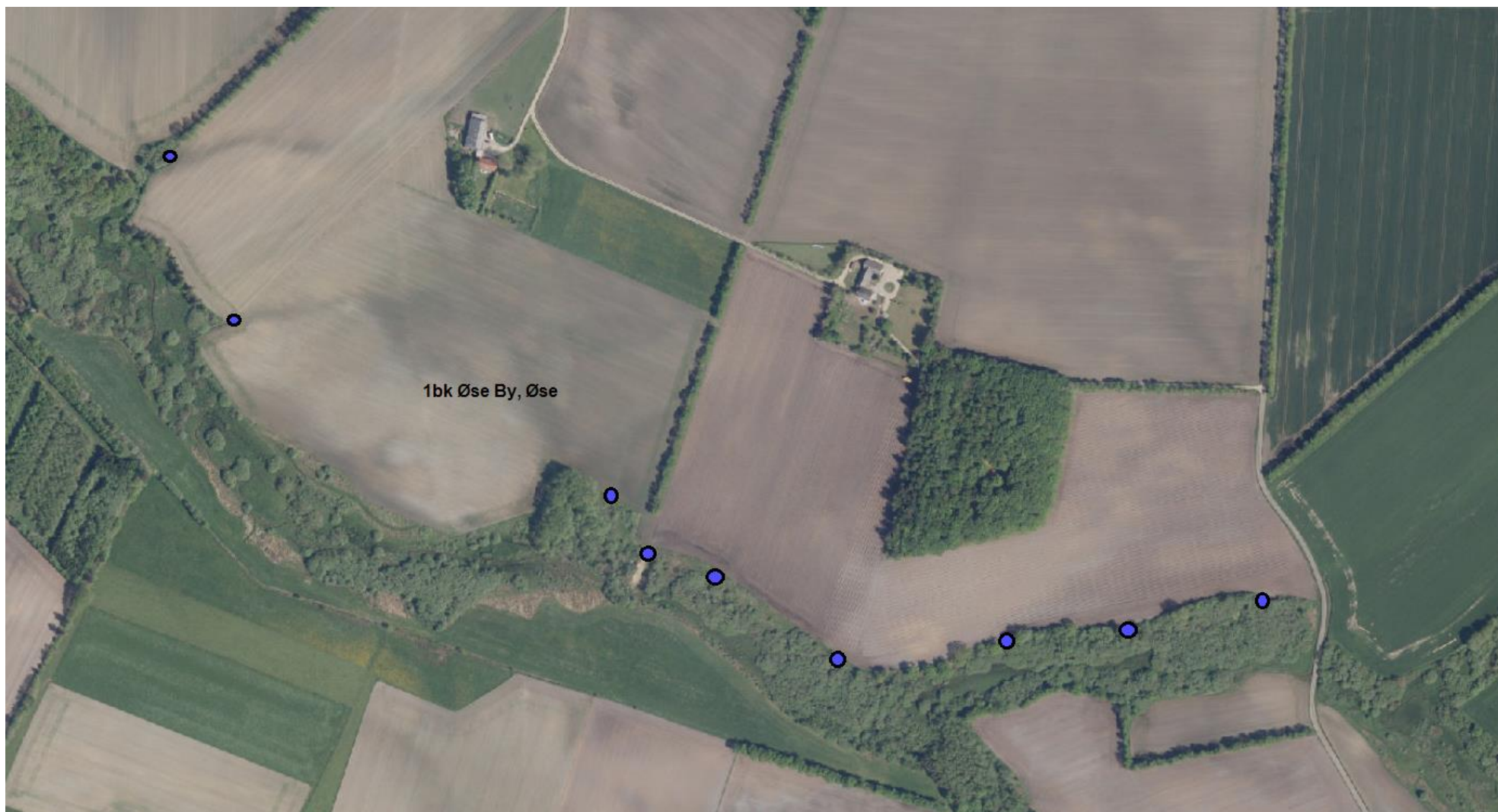
Figur 4. Markering af kendte drænudløb (med en vis usikkerhed)
