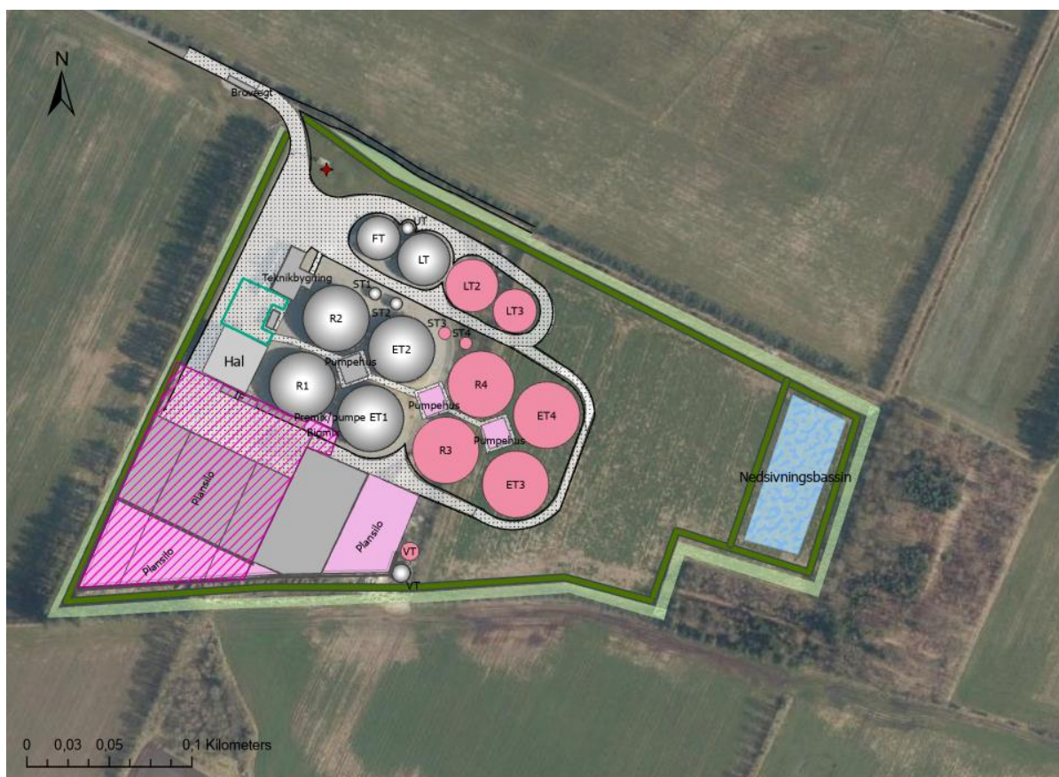
Figur 11.2 - Areal hvorfra der opsamles overfladevand er markeret med lyserøde striber. Der er tale om et samlet areal på ca. 11.680 m 2 .
