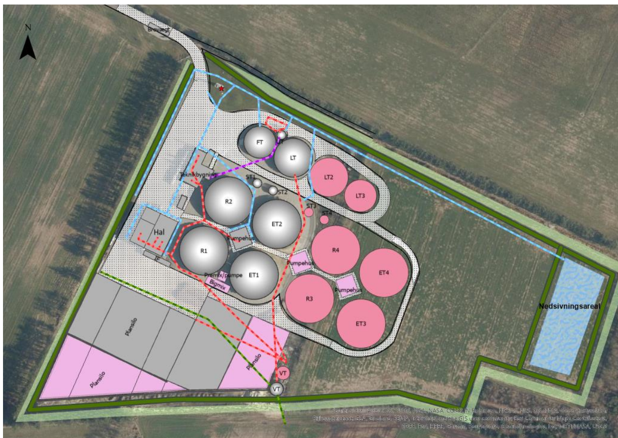
Figur 11.1. Afløbsskitse Outrup Biogas. Røde linjer (kat.3): urent overfladevand. Grønne linjer (kat.1): Plansilosaft (udsprinkles). Blå linjer (kat.2): Rent overfladevand, nedsives. Lilla linjer: Udskiftning af væske i biofilter.
