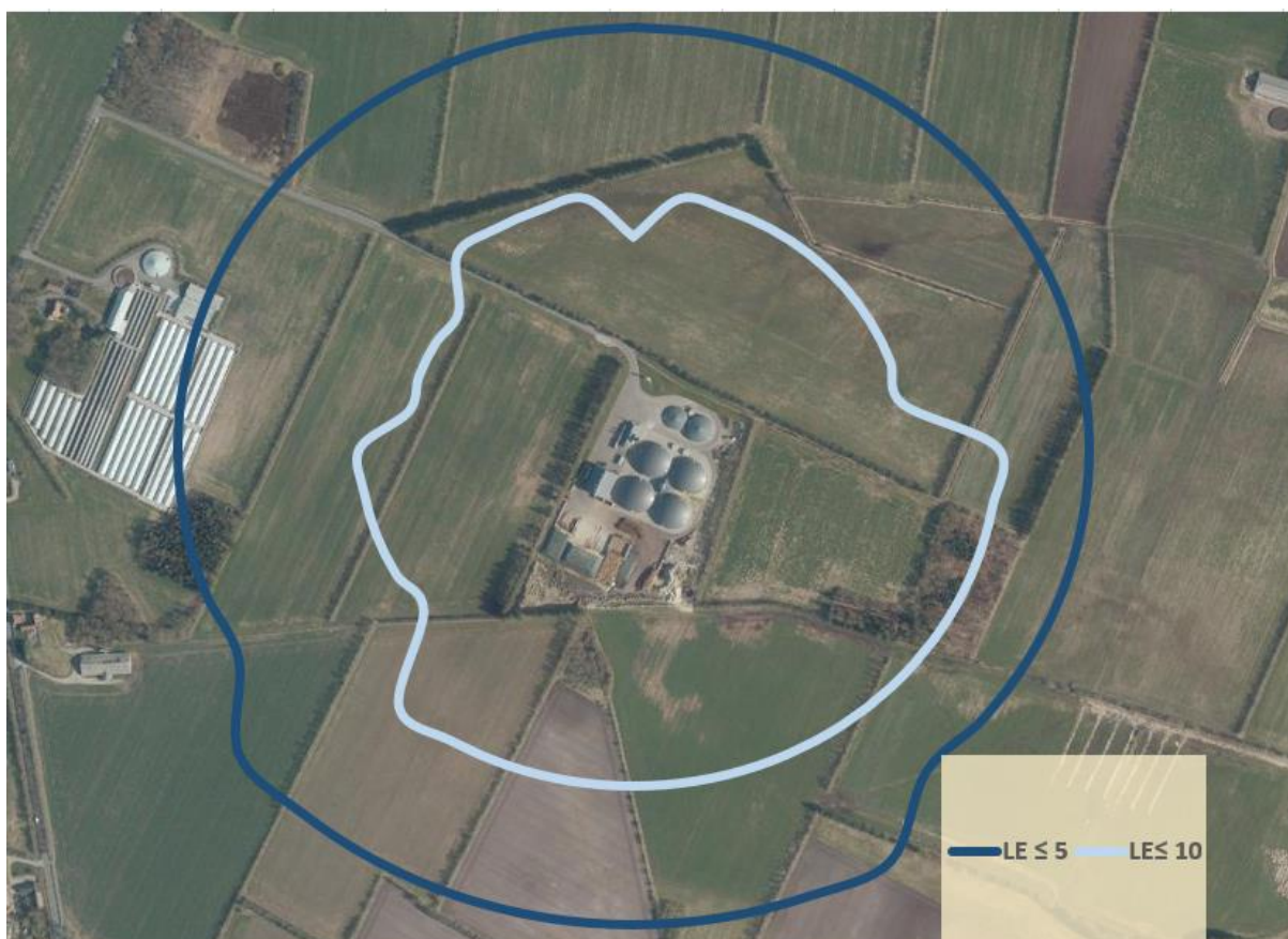
Figur 10.2 - Grafisk afbildning af lugtspredningen fra Outrup Biogas.
