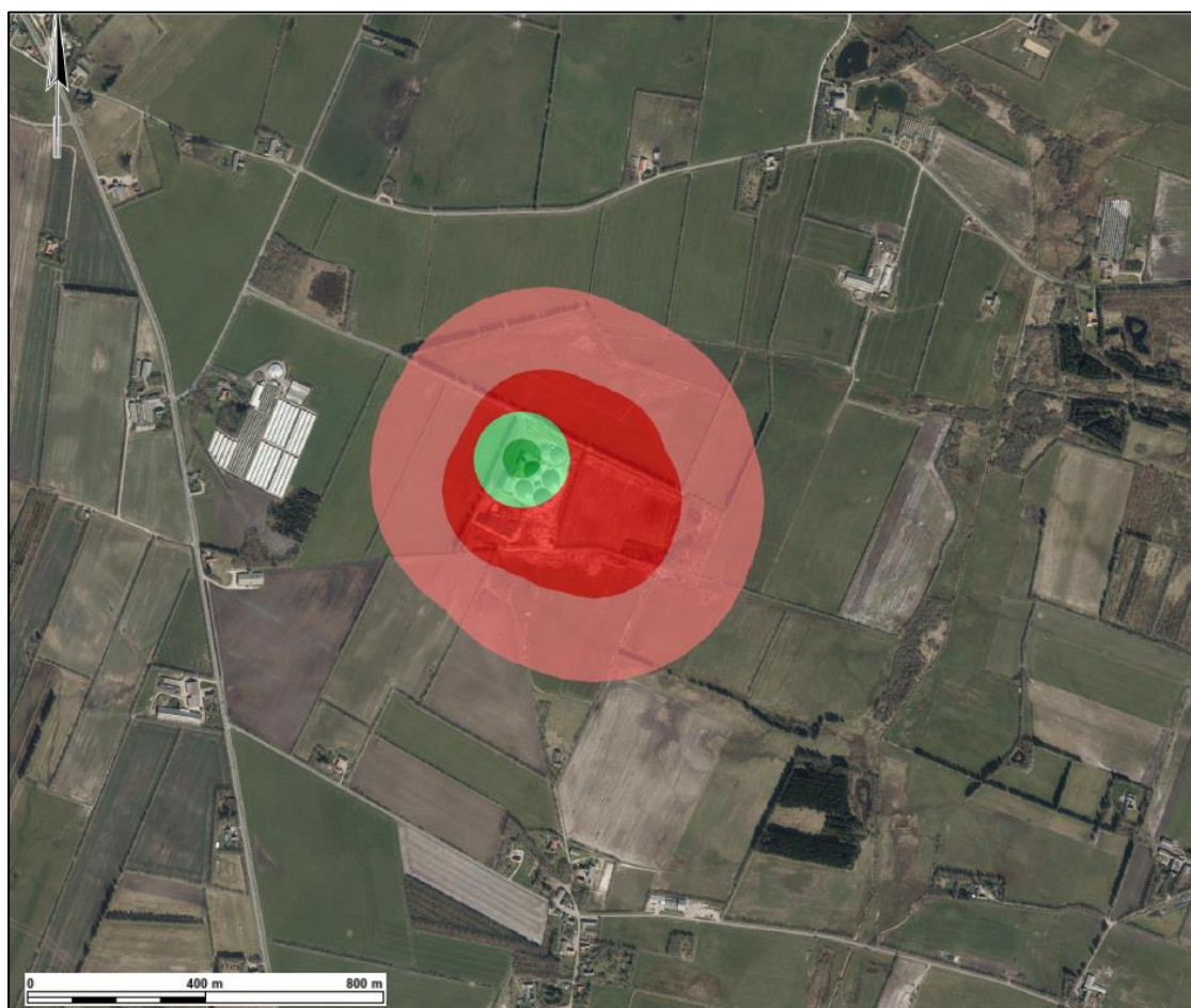
Figur 14.1 Konsekvenszoner for eksplosionstryk (5 kPa (lys rød) og 20 kPa (mørk rød)) for enkelte tanke og for opgraderingsanlæg (5 kPa (lys grøn) og 20 kPa (mørk grøn)).
