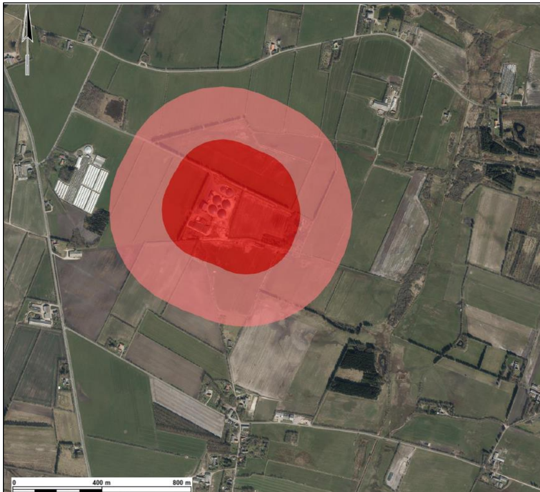
Figur 14.2 Konsekvenszoner for eksplosionstryk ved dominoeffekt (5 kPa (lys) og 20 kPa (mørk)). Dominoeffekten er vist for gasbærende tilstødende tankpar.
