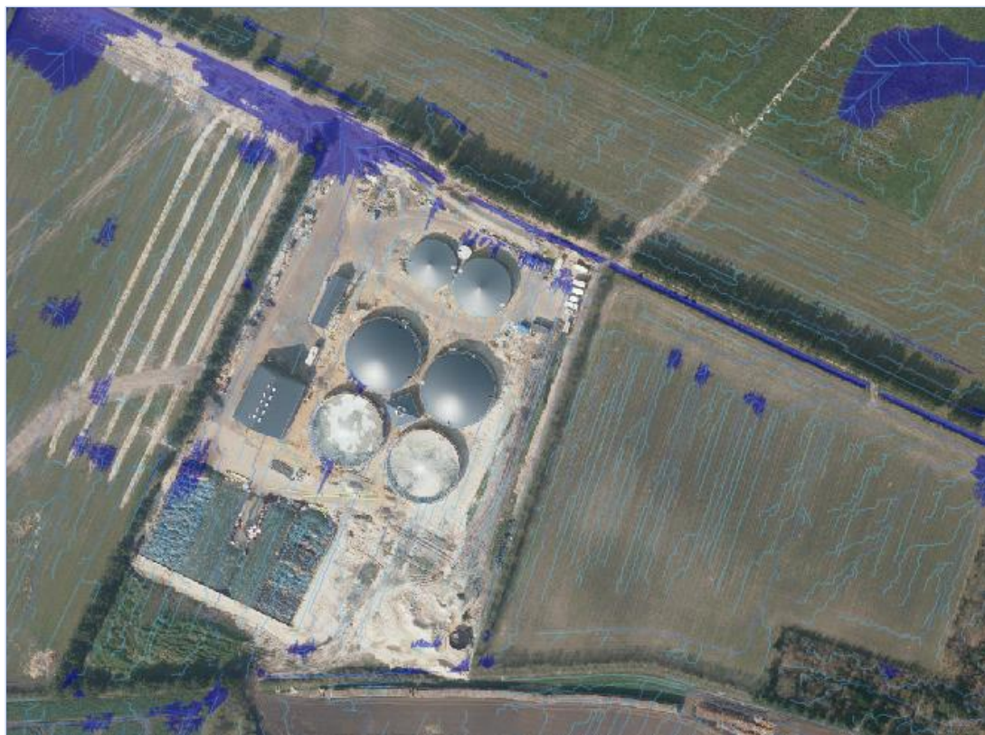
Figur 11.3 – Risici for vandsamlinger og strømretninger i området omkring Outrup Biogas ApS.
