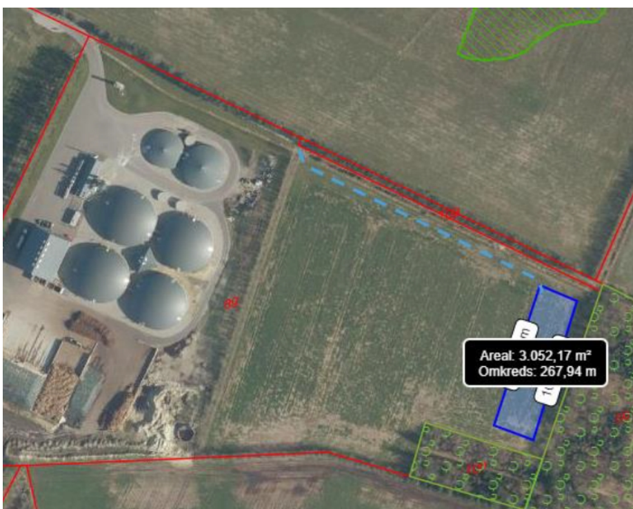
Figur 3 Placering af lavningen (nedsivningsarealet) samt rørledningens placering. Skitse fra ansøgningsmaterialet.
