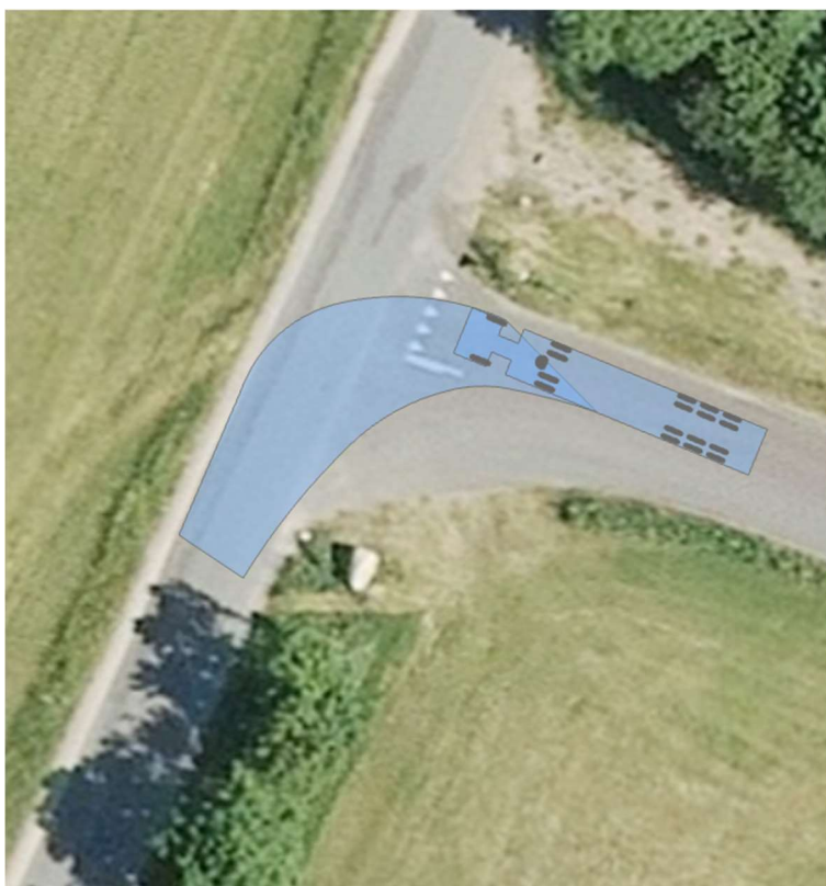
Illustration 6: Venstresving fra adgangsvejen til Lundtangvej.
