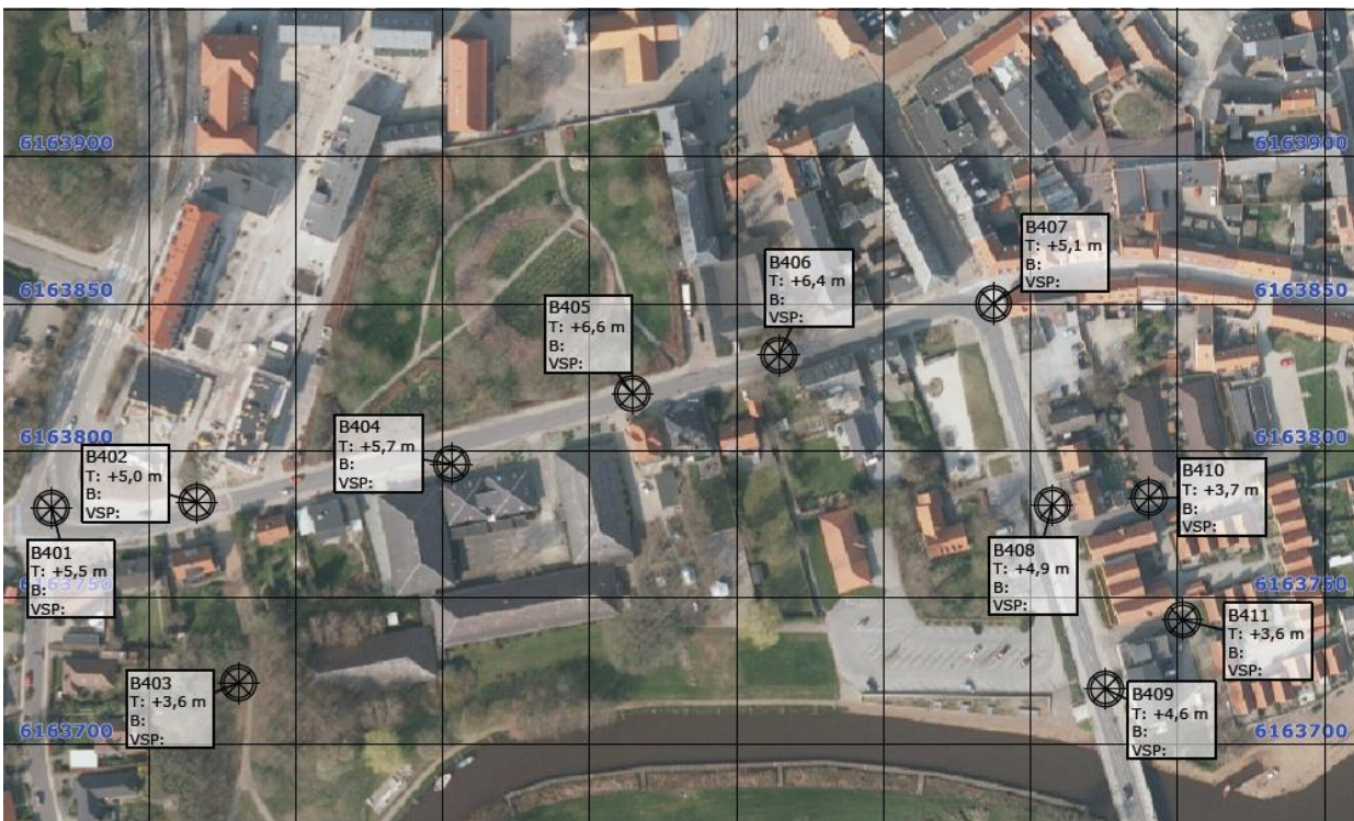
Figur 2: Placering af geotekniske boringer B401-B411, B410 og B411 er ikke relevante for projektet.
