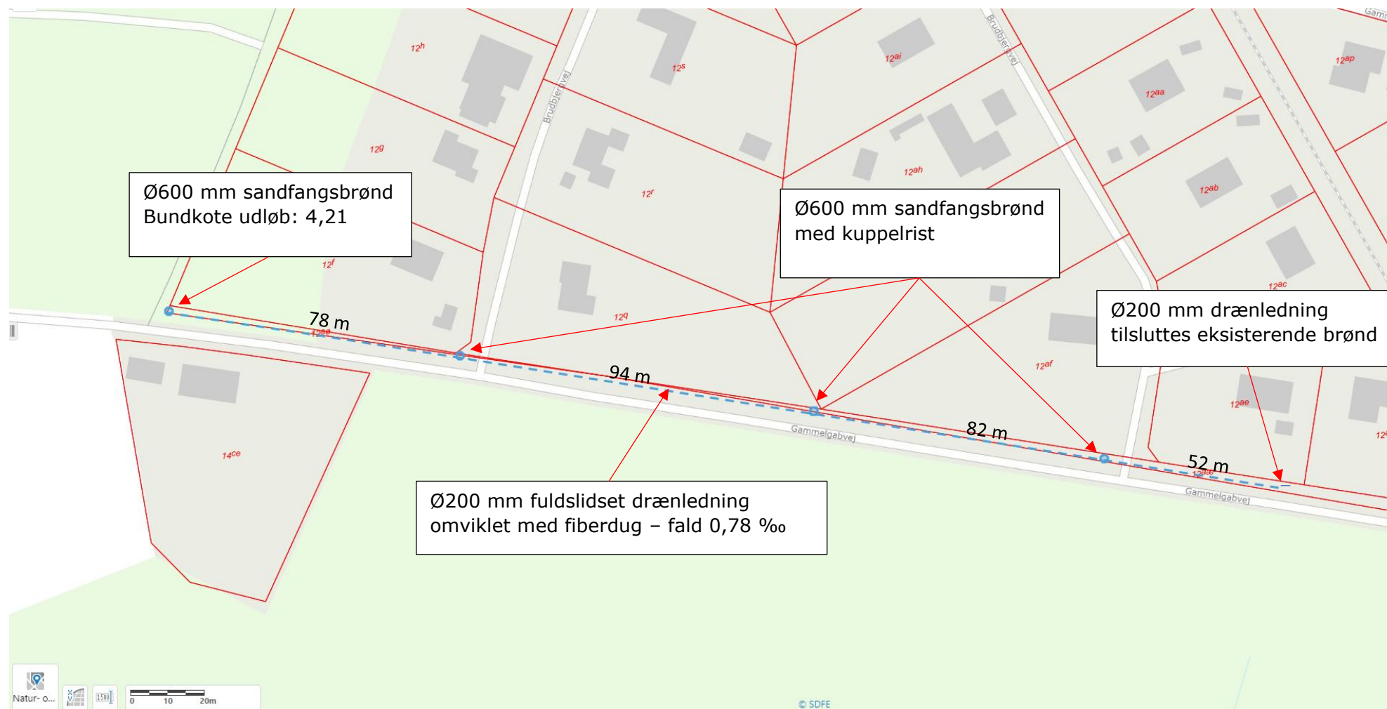
Etablering af ny drænledning langs Gammelgabvej. Sandfangsbrønde etableres med et sandfang på 60 cm under udløbskote.
