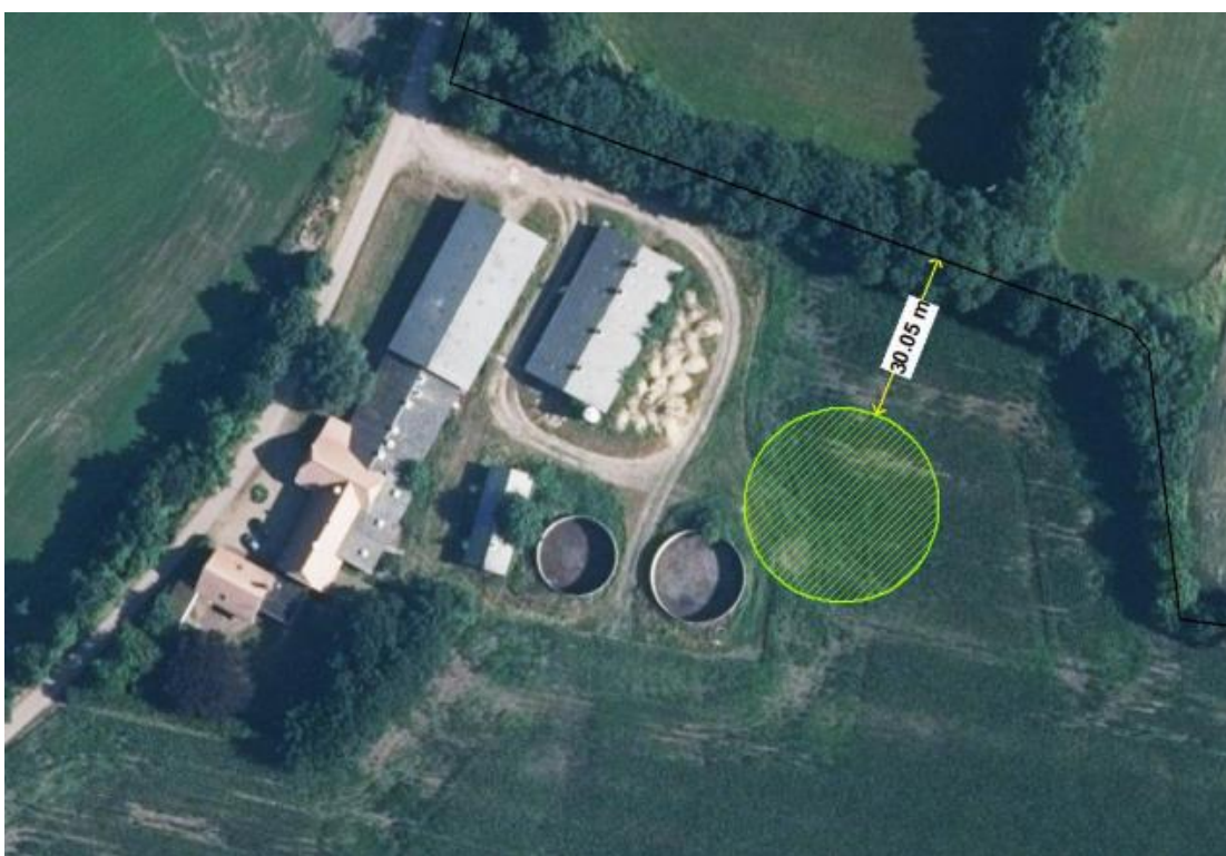
Figur 1. Den ny gyllebeholders placering på Stilbjergvej 28 med overholdelse af afstandskravet på 30 meter til naboskel mod nord. Figur udarbejdet af ansøger.
