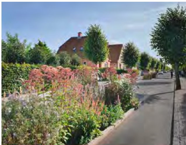
Regnvandsbed som fartdæmper / Middelfart KlimaBy (GHB)
