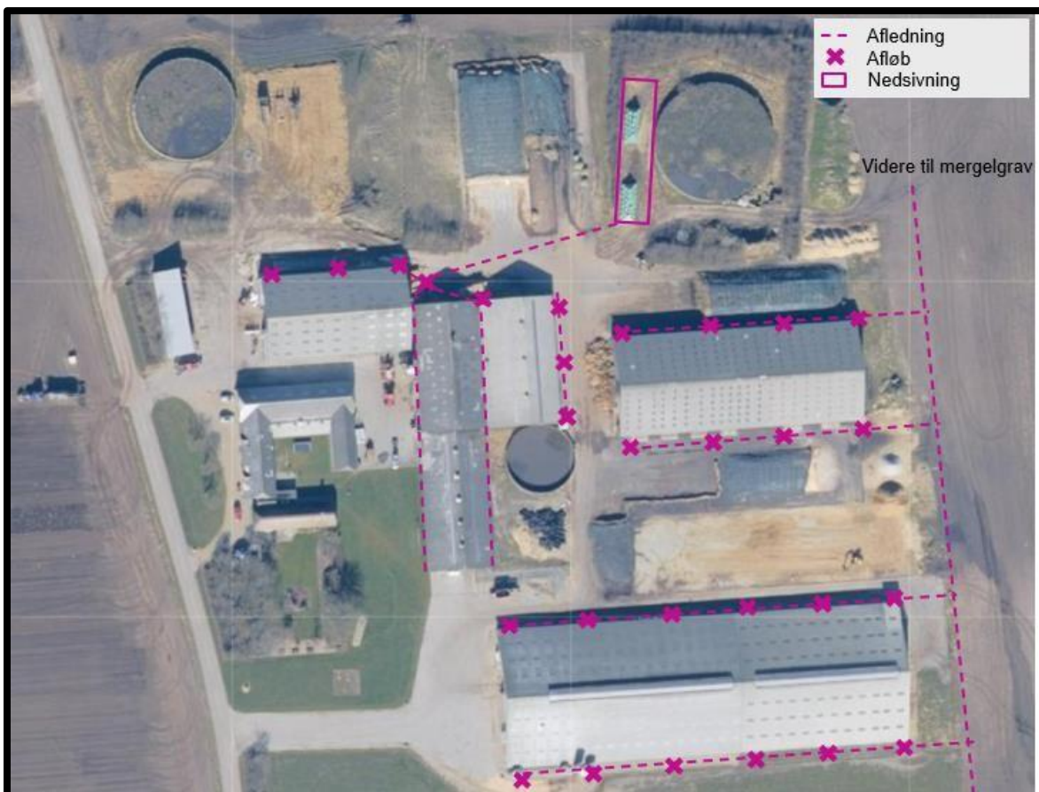
Figur 13. Afløbning af tagvand
