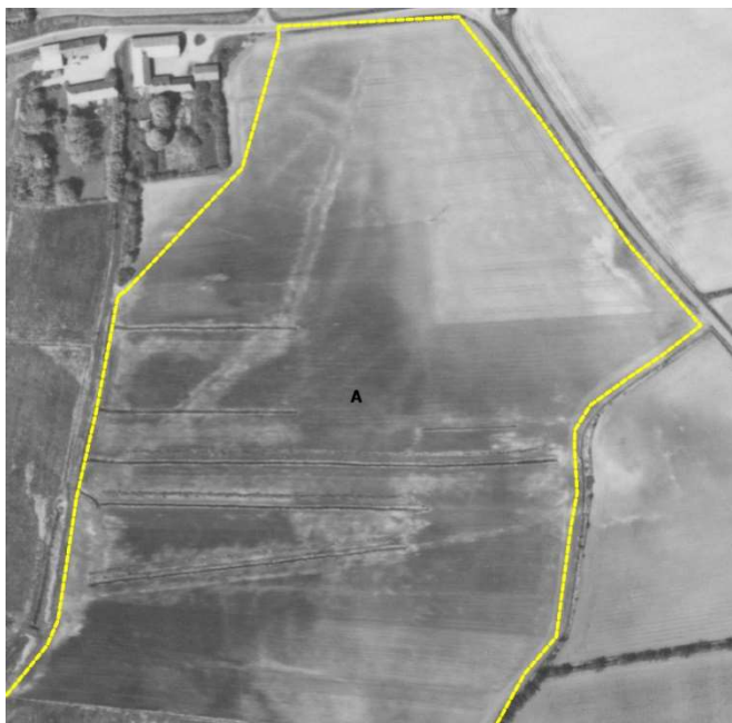
Figur 6. Luftfoto over den nordligste del af projektområdet taget i 1985. På billedet ses en rørledning fra nord, der gennemskærer arealet og fortsætter til det offentlige vandløb mod sydvest på billedet. Lyse farver i marken viser spor efter et antal gamle dræn. Fungerende dræn, som ikke påvirker afvandingen af arealer uden for projektgrænsen, knuses i anlægsfasen.
