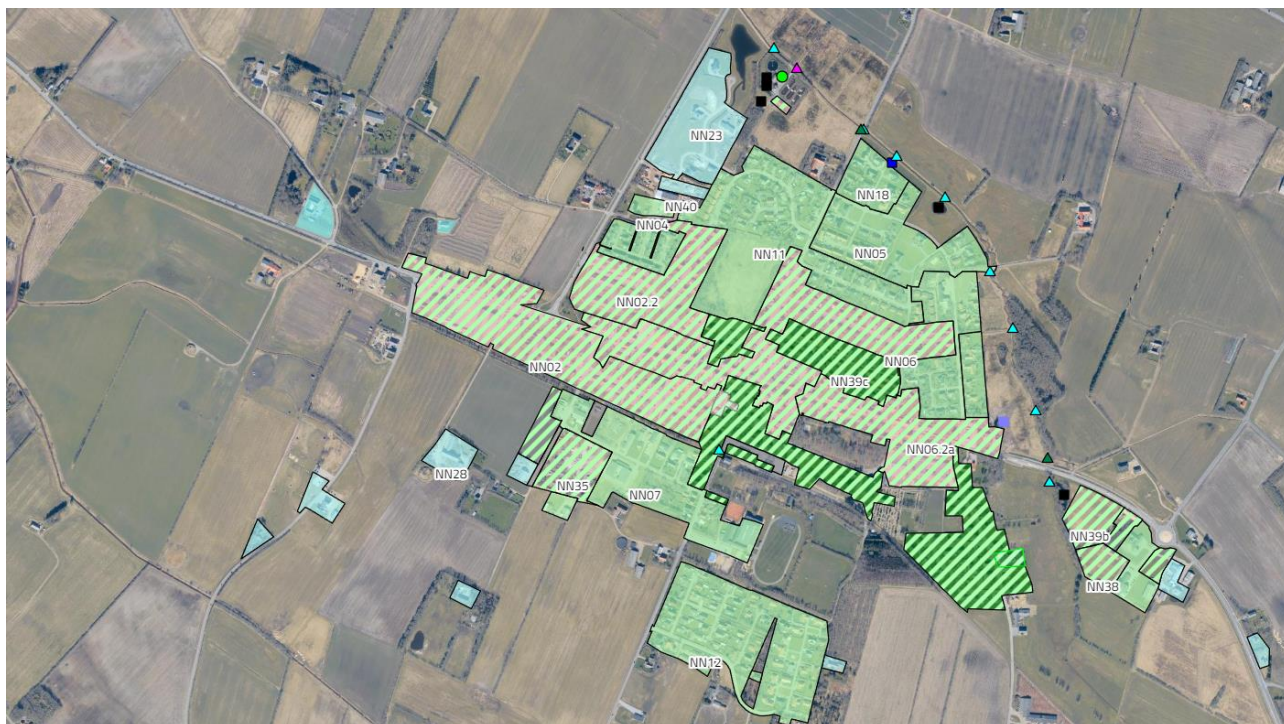
Figur 3 Eksisterende oplande i Nørre Nebel. Grøn og stribet mørkegrøn er separatkloakeret, blå er spildevandskloakeret og stribet lysegrøn er fælleskloakeret planlagt separatkloak
