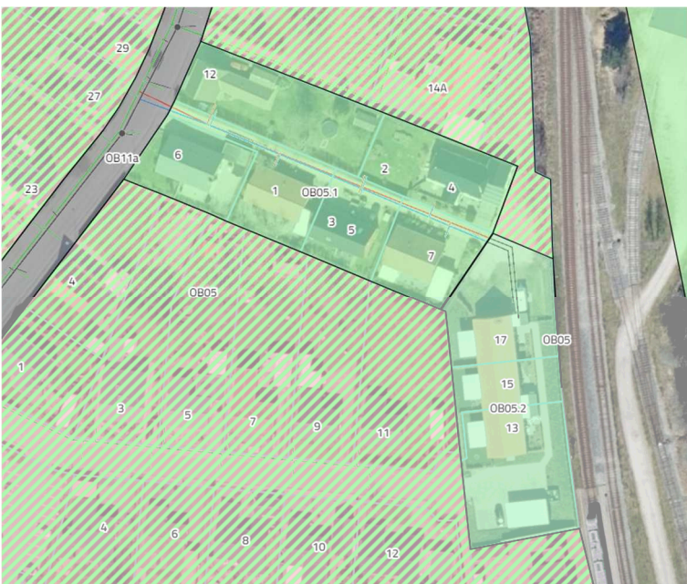
Figur 7 Revideret spildevandsplan ved Stationsbakken 1, 2, 3, 4, 5 og 7 samt Nørregade 12 i Oksbøl. Grøn er separatkloak. Grøn skravering er fælleskloakeret planlagt separatkloakeret.
