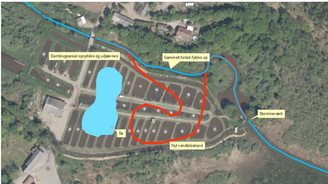
Figur 5. Oversigt over de tekniske anlægsarbejder i forbindelse med fjernelse af dambrugets stemmeværk.
