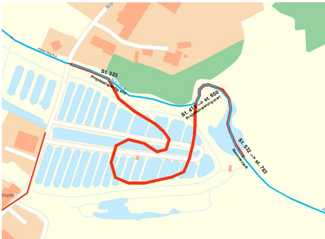
Figur 7. Nuværende og projekterede stationeringer for vandløbet ved dambruget. Genslyngningen forlænger vandløbet med 231 m.
