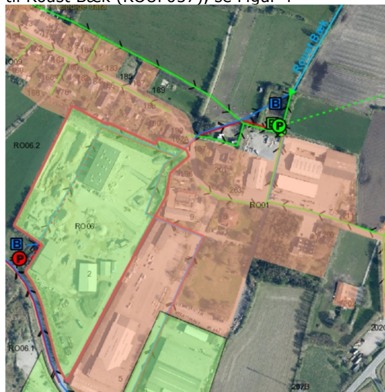
Figur 4 viser kloakledninger, bassiner (B), pumpestationer (P), bygværker (⊗) og overløb (V), hvor grønne ledninger er fælles, blå er regnvand og rød er spildevand. På figuren til venstre er de grønne områder separatkloakerede og de orange er fælleskloakerede.
