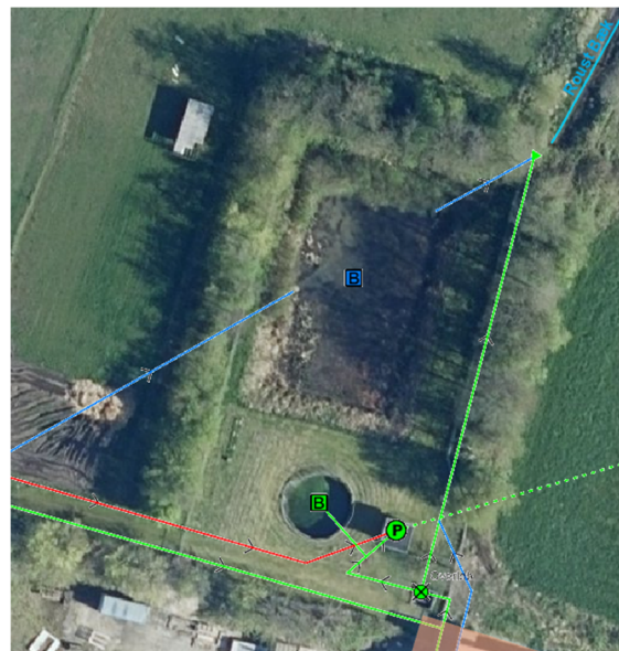
Figur 4 viser kloakledninger, bassiner (B), pumpestationer (P), bygværker (⊗) og overløb (V), hvor grønne ledninger er fælles, blå er regnvand og rød er spildevand. På figuren til venstre er de grønne områder separatkloakerede og de orange er fælleskloakerede.
