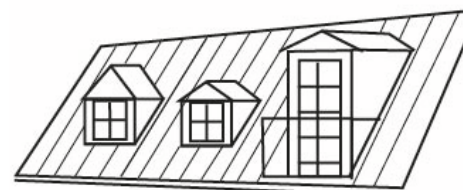
Eksempler på tagkviste og indbygget mindre tagaltan
