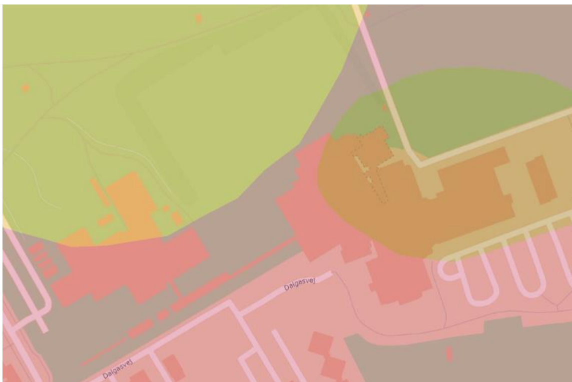
Figur 1. Uddrag af det geologiske kort for området 1:25.000. Det ses at der kan forventes sand- og lerjord inden for arealet for den nye bane.
