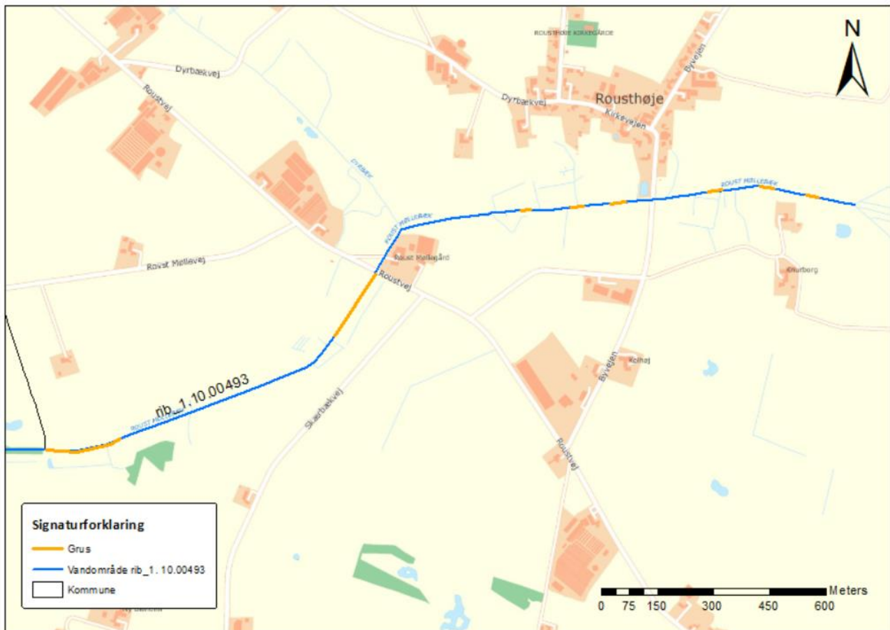
Figur 14. Placeringen af gydegrus i Roust Møllebæk (orange). Spærringerne fjernes og der udlægges gydegrus på en længere strækningen henover disse. Opstrøms spærringerne anlægges der seks gydebanker.
