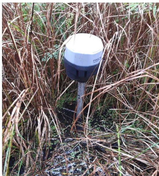
Figur 13 Opmåling af fast bund i åslynge gennem hængesæk. Her er ca. 1,8 m til fast bund.
