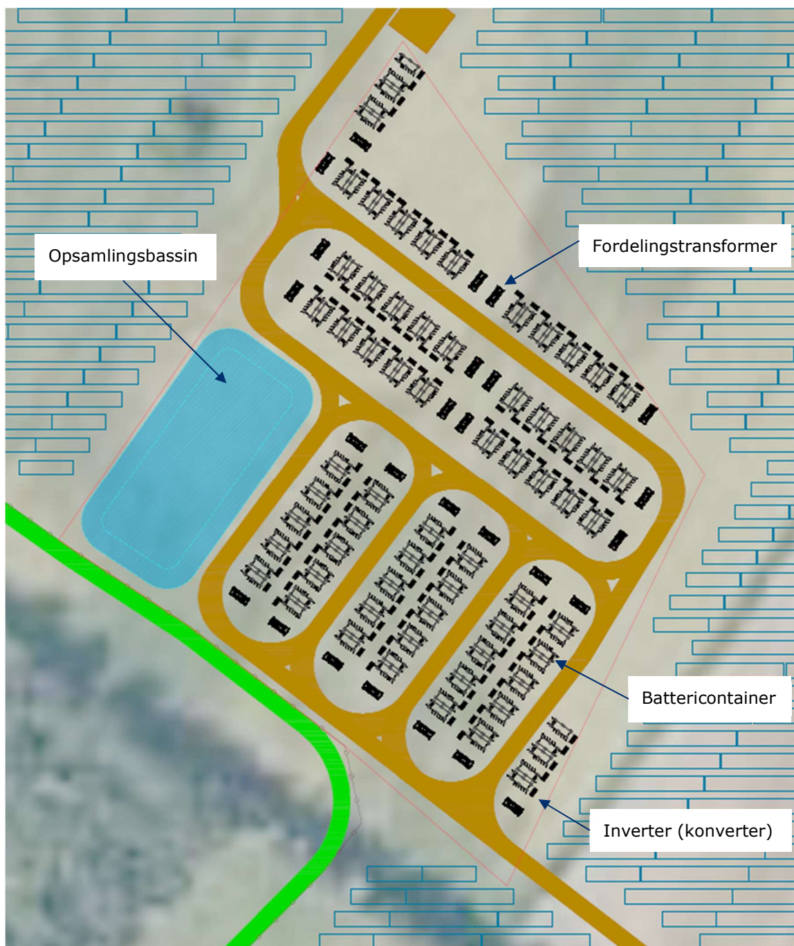
Figur 7 – Vejledende parklayout for solcellepaneler på faste stativer og batterianlæg. Blå struktur er solceller og gul signatur er interne serviceveje. Beplantningsbælter er vist med grønne nuancer. Placering af opsamlingsbassin er vist med blå. Battericontainere, fordelingstransformere og placering af invertere er vist med sort.
