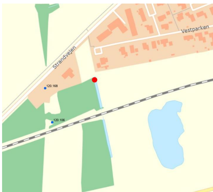
Figur 2: Udledning af ren- og prøvepumpningsvand til grøft syd for regnvandsbassin
