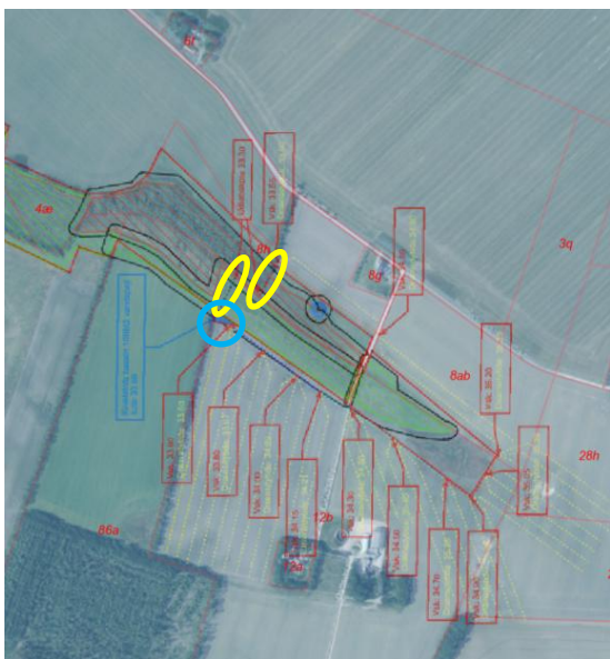
Luftfoto (Geodatastyrelsen, GeoDanmark, KDS, Hexagon, Varde Kommune) overlagt med plantegning af placeringen af de to lukkede dræn (gule cirkler) og bassinet (blå cirkel) fra ansøgningen.
