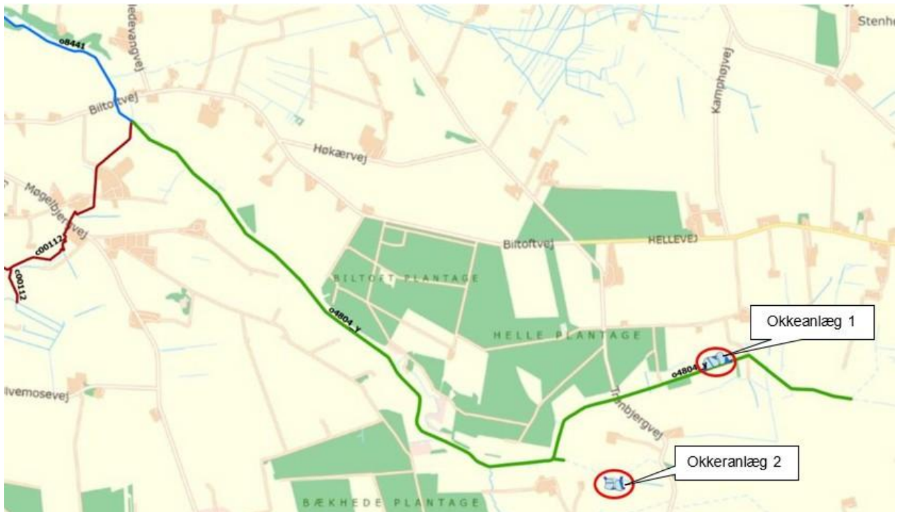
Figur 17. Forslag til placering af de to okkeranlæg i Vrenderup Mosebæk (okkeranlæg 1, øst) og ved Rørledningen Fåborg-Tranbjerg (okkeranlæg 2, vest).
