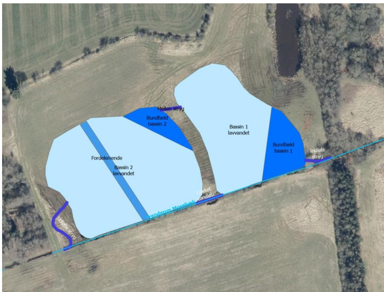
Figur 18 Skitse over placering og udformning af okkeranlæg 1 i Vrenderup Mosebæk. Vandet løber gennem anlægget fra østlige bassin 1 og videre gennem vestlige bassin 2. Målforhold 1:1000.
