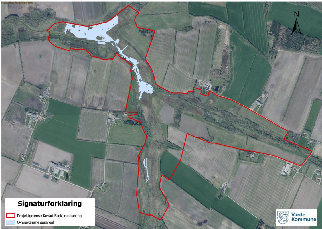
Figur 12. Oversvømmelsesarealet er en opgørelse af de arealer som oversvømmes ved en max vandføringssituation i HEKRAS.
