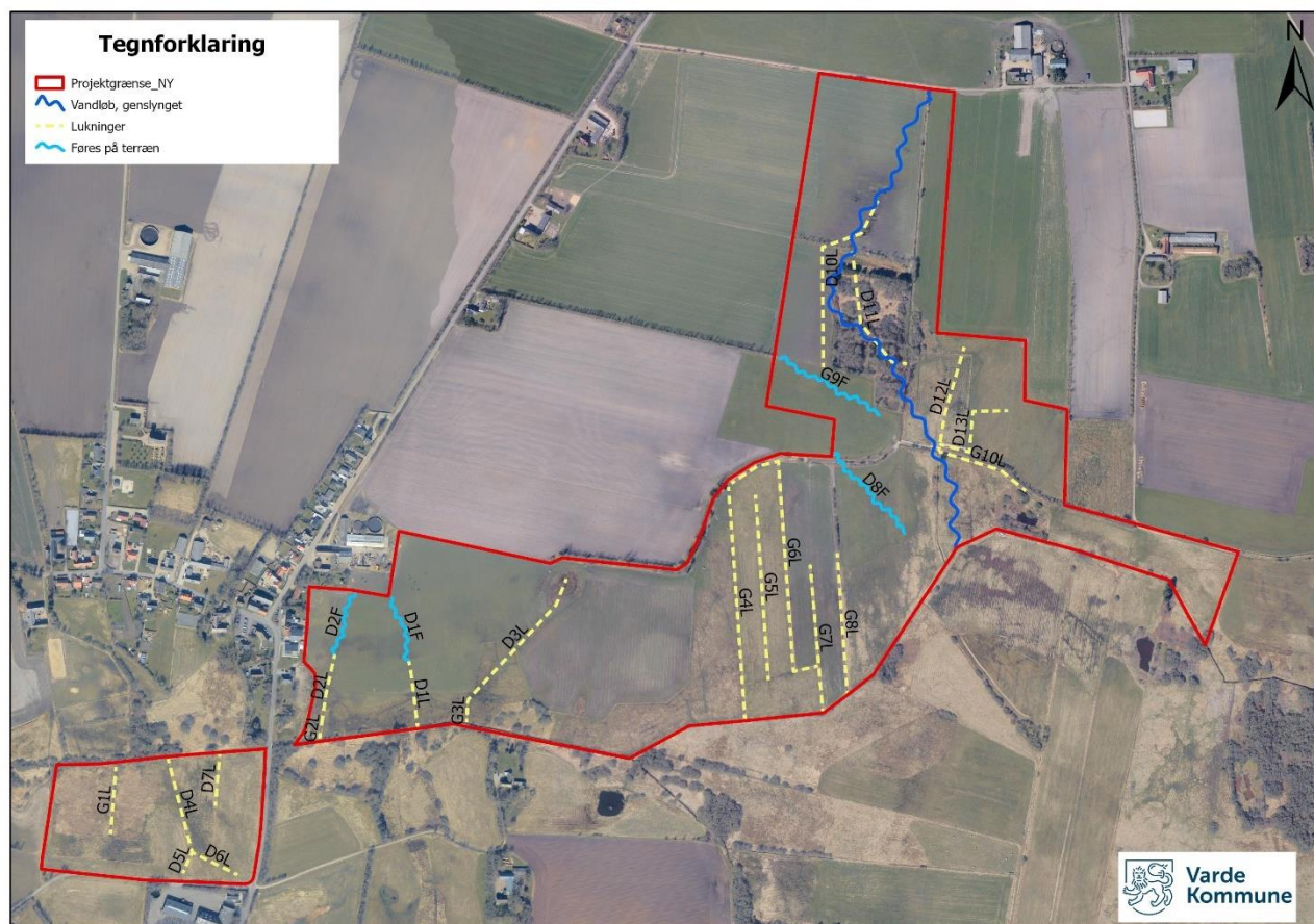
Figur 19. Anlægstiltag med lukning af grøfter og dræn, etablering af fordelerrrender, omlægning af vandløb og afværgetiltag.
