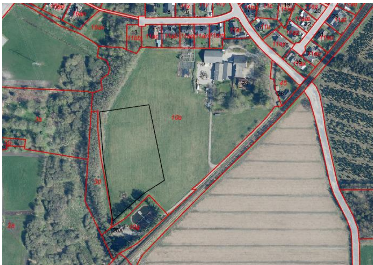
Figur 1 En cirka placering af regnvandsbassinet i forhold til eksisterende bebyggelse og veje. Sort streg indikerer placeringen af regnvandsbassinet samt tilhørende ledningsanlæg og adgangsveje. Der kan blive ændret lidt placeringen ved den endelige projektering.
