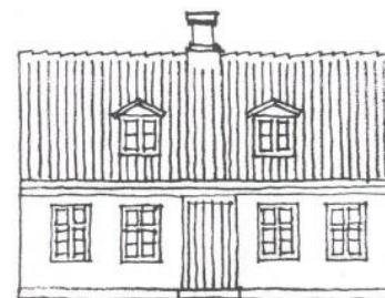
Kviste placeres symmetrisk i tagfladen, "i fag" med langsides vinduer
