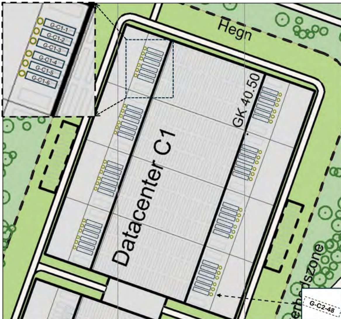
Figur 36 Placering af afkast. Der placeres ét afkast for hver nødgenerator. Afkast er vist med gul cirkel.
