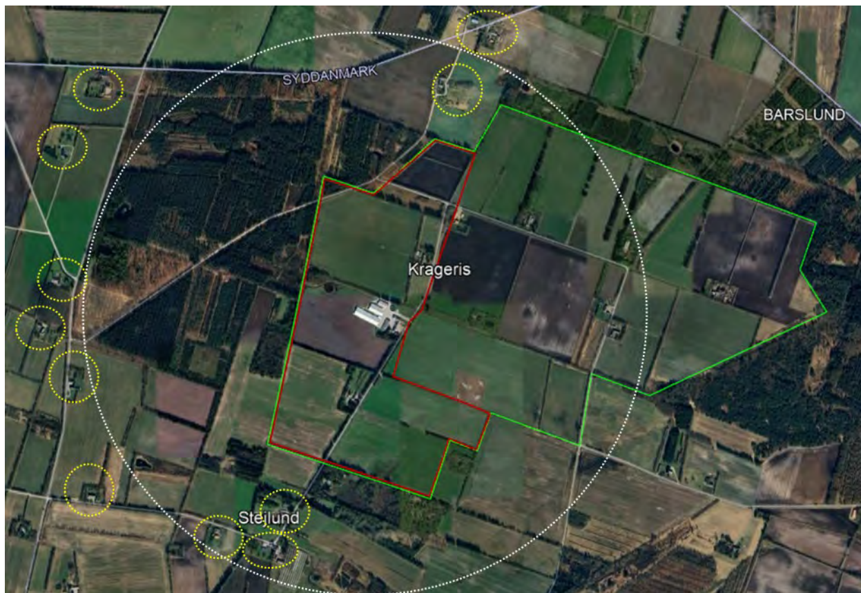
Figur 35 Placering af de nærmeste naboer (gul) til plan- og projektområdet, særligt datacentret. Den store hvide cirkel har en radius på 1 km. Nærmeste naboer til et afkast er hhv. nord og syd for området. Området inden for de røde linjer er, hvor datacenter og tilhørende funktioner kan være placeret.
