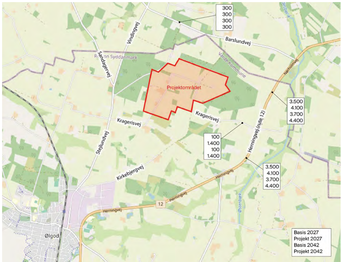
Figur 40 Beregnet trafikbelastning opgjort som hverdagsdøgntrafik (HDT) henholdsvis med og uden plan- og projektområdet i 2027 og 2042. Alle tal er rundet op til nærmeste 100.
