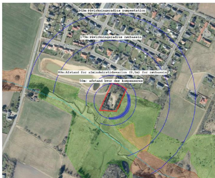
Figur 3 Oversigt over påvirkningsområdet ved grundvandssænkning. Det blå markeret område overrisles med oppumpet grundvand til kompensering af §3 beskyttet natur.
