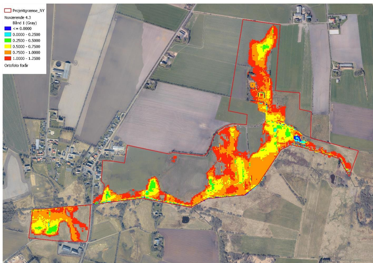
Figur 7. Modellering af årsmiddel grundvandsstand i området, baseret på indmålte grundvandsstande
