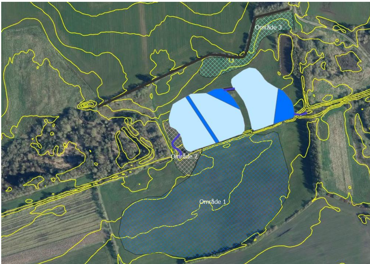
Figur 19 Område 1 til 3 til aflægning af opgravet materiale (skraverede områder). Et beskyttet jorddige er markeret med sort streg nord for område 3. Nuværende højdekurver med 0,5 m interval er vist med gult.
