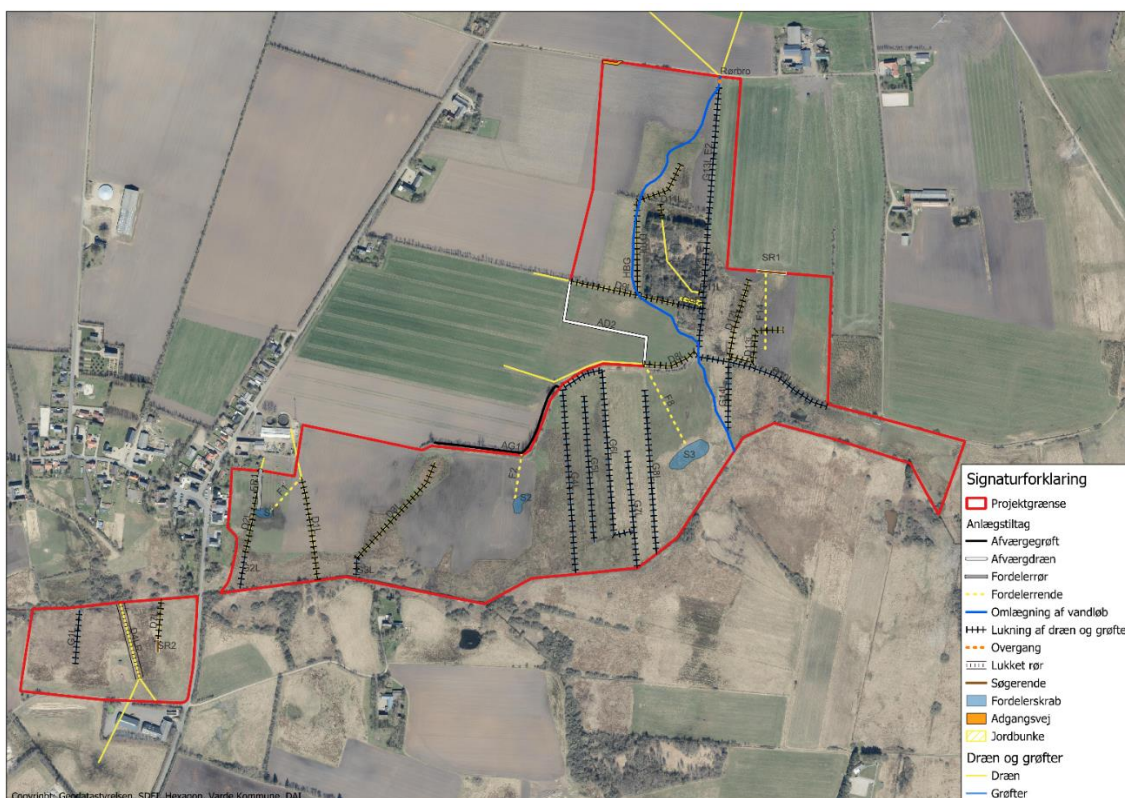
Figur 1 Anlægstillæg med lukning af grøfter og dræn, etablering af fordelerrender, omlægning af vandløb, skrab og sikringstiltag mm.
