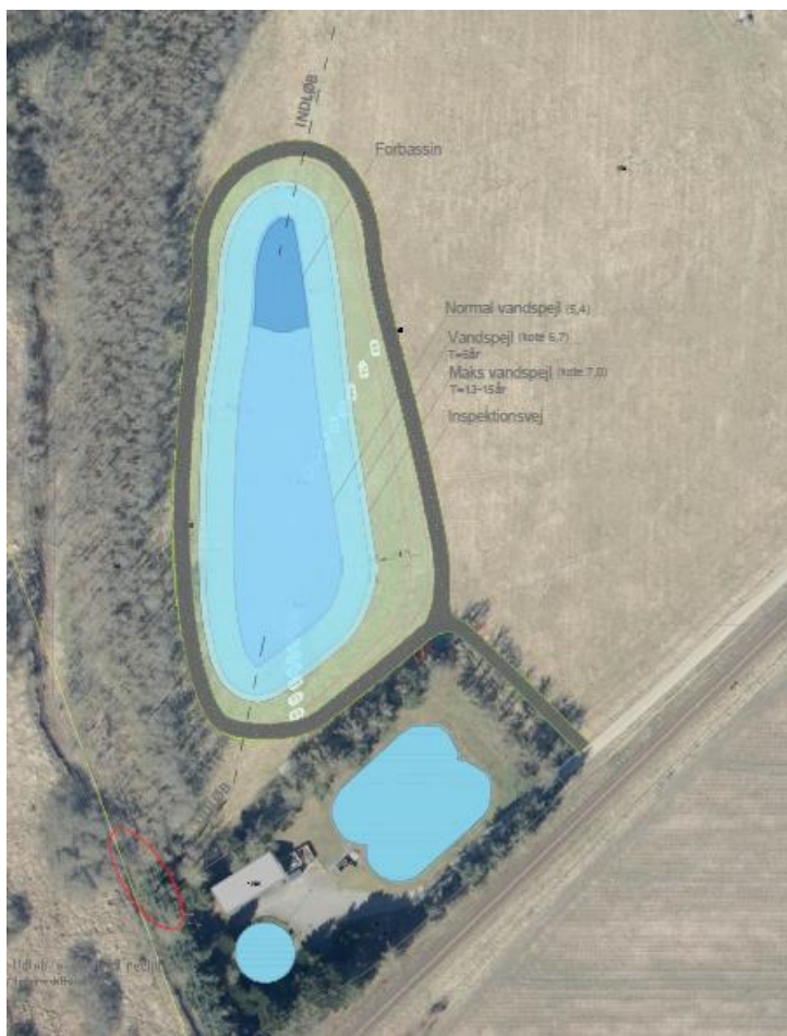
Figur 3 Foreløbig skitse over placering af bassin og tilhørende ledningsanlæg samt adgangsveje. Bliver detail projekteret, for overholdes af krav til udledning og jordbundsforhold.
