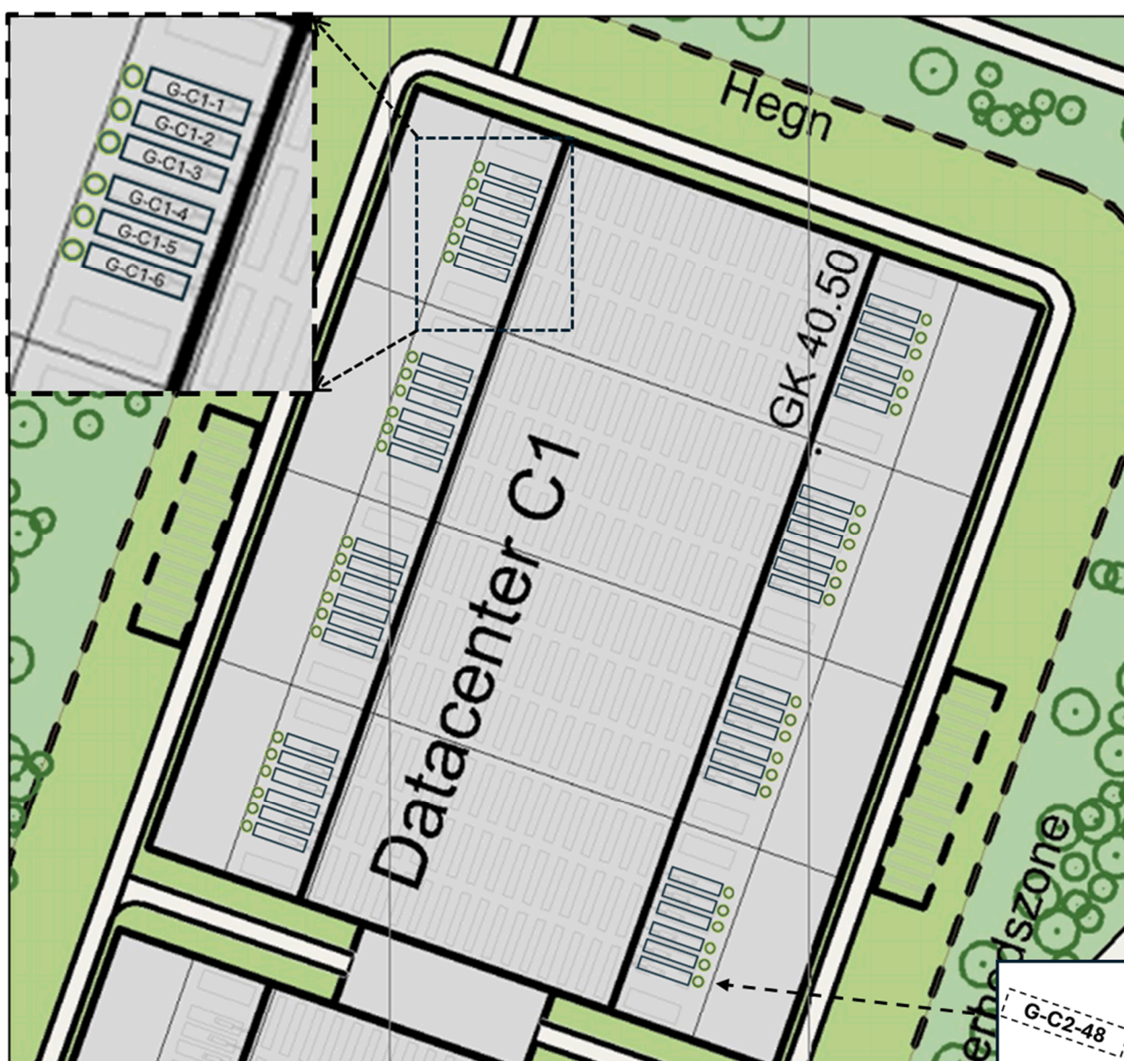
Figur 2-3 Datacenterafsnit med opdeling i fire blokke, placering af 12 generatorer pr blok og placering af en skorsten ved hver enkel generator. Nummereringen af generatorer og skorstene følger nummeringen af datacenteret.
